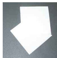
Tenká plastová deska k oddělování dvou polovin kulovité formy
