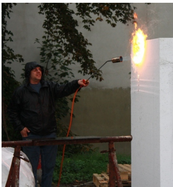
Obrázek: Blok fasádního EPS vystavený přímému plameni
