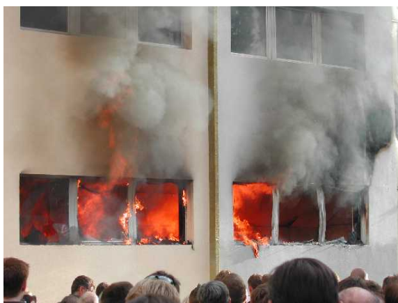
Obrázek: Fasádní požární zkoušky (po 27 minutách)
